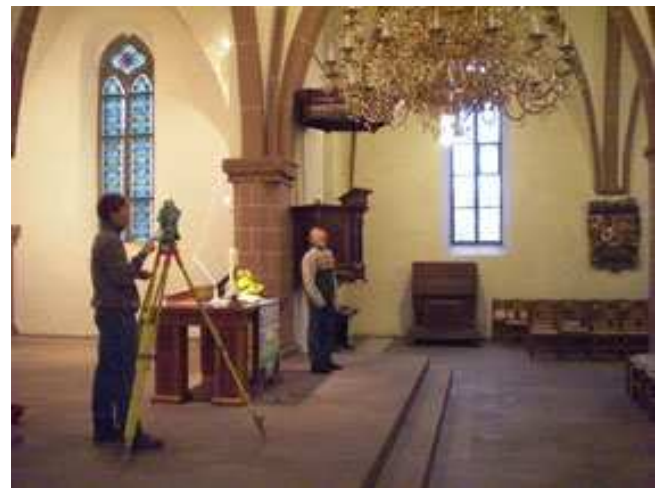
Bauwerksvermessung / Erfassung der Bausubstanz
